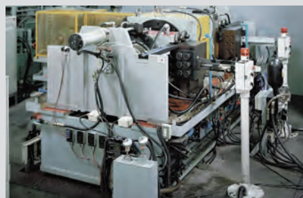
Испытательный стенд для подшипников, использующихся в рабочих валках прокатных станов
