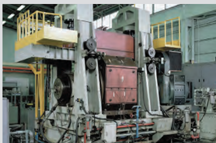
Испытательный стенд для подшипников, использующихся в опорных валках прокатных станов
