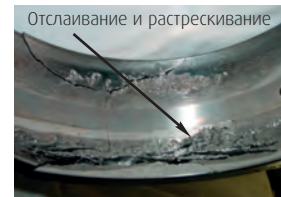
Отслаивание и растрескивание Поверхность дорожки качения внешнего кольца
